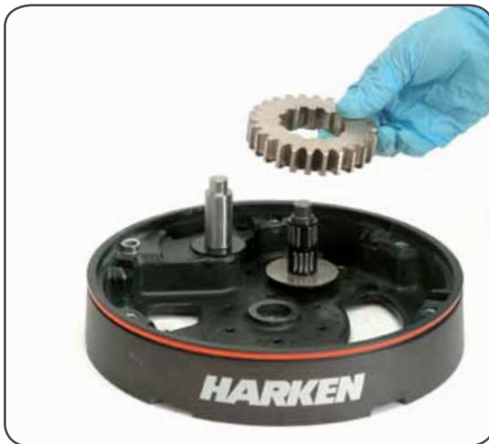
16. Remove the gear n°10
