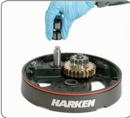
14. Remove roller bearings n°15
